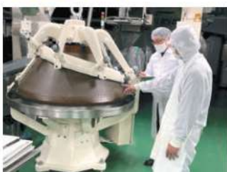
丸目機(ラウンダー)の清掃状況のチェック
