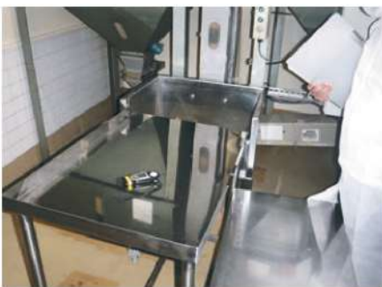
精米選別台の照度確認作業の様子
