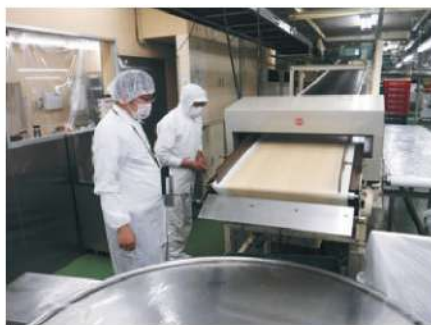
金属探知機の作動確認の様子
